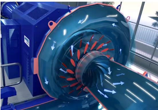
Francis-Turbine mit Generator von Andritz für Hochdruckspeicherkraftwerke. Sie kann in Zeiten mit überschüssigem Strom das Wasser wieder hochpumpen.
